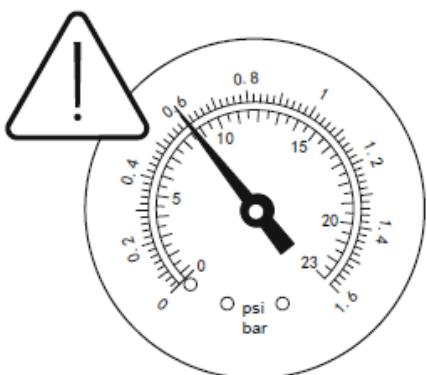
**UPOZORNENIE:** Pred začatím akejkoľvek údržby sa musíte uistit', že je pieskový filter vypnutý a odpojený. V opačnom prípade hrozí väzne riziko poranenia alebo smrti. S narastajúcim objemom nečistôt v pieskovom filtri sa bude zvyšovať hodnota tlaku na tlakomere. Keď je hodnota tlaku na tlakomere 0,45 baru (6,5 PSI) alebo vyššia, je čas vyčistiť piesok. Ak chcete vyčistiť pieskové lôžko, postupujte podľa všetkých pokynov uvedených vyššie v časti: Spätné preplachovanie a vyplachovanie.
