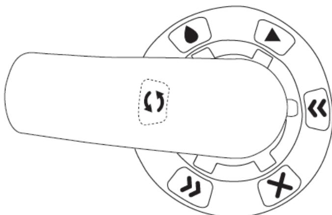
Rukoväť regulačného ventilu zatlačte dolu a otočte ju do požadovanej polohy. Pred zmenou funkcie regulačného ventilu vždy vypnite pieskový filter, aby ste predišli poškodeniu zariadenia.
